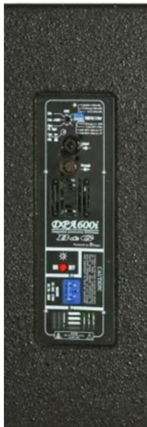
Конструкция усилителя очевидна из иллюстраций. Панель имеют ширину 100 миллиметров и длину 310 миллиметров. По периметру панели находится 8 крепёжных отверстий. Глубина 75мм. Для установки панели деревянный корпус АС должен быть подфрезерован с внешней стороны на глубину около 10 миллиметров. Ширина зоны установки составляет 15мм по всему периметру. Установку можно производить и изнутри акустической системы.
